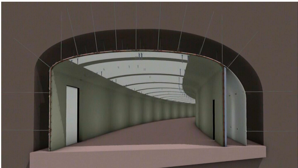
Figur 3. Tunnelvalv monterat på Norra länken i Stockholm. (Efter Veidekke AB).
